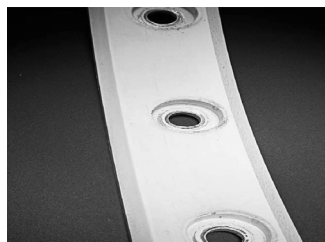
Рис. 5. Цилиндрическое отверстие в алюминиевой рамке
